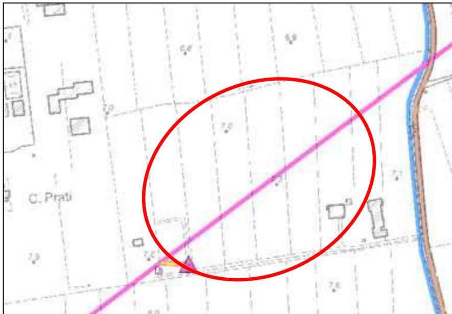
Linea Guida per l'applicazione del paragrafo 5.1.3 dell'Allegato al DM 29.05.08 - 5.2 ALLEGATO B "DPA PER LINEE MT E CABINE SECONDARIE", scheda B4c "fascia 10 metri per parte dall'asse del traliccio"
