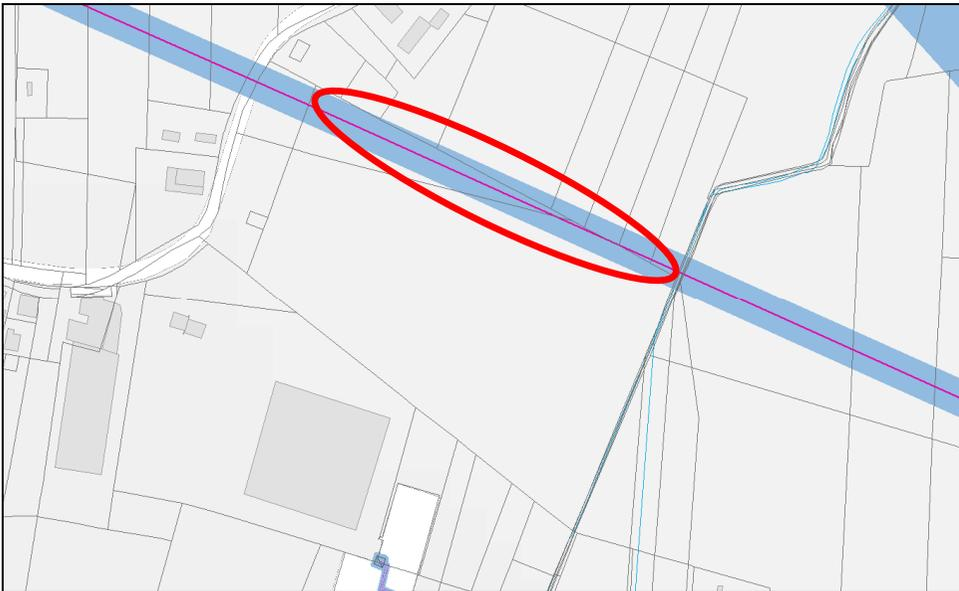
Riferimento normativo: Linea Guida per l'applicazione del paragrafo 5.1.3 dell'Allegato al DM 29.05.08 - 5.2 ALLEGATO B "DPA PER LINEE MT E CABINE SECONDARIE", scheda B4c "fascia 10 metri per parte dall'asse del traliccio"
